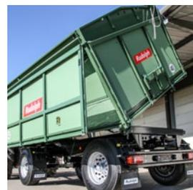
Seitenwand in Rahmenkonstruktion mit Industriesperrholz, oben pendelnd gelagert
