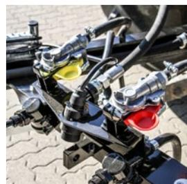
Zentrale Aufnahme für Hydraulik und Druckluftanschlüsse
