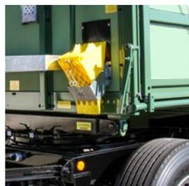
Mechanisch öffnende Bordwandentriegelung, wahlweise hydraulisch erhältlich
