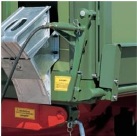
Hydraulisch öffnende Bordwandverriegelung
