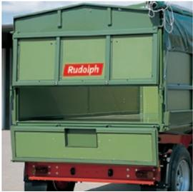
Geteilte Rückwand mit einem (Abb. oben) oder drei (Abb. unten) Auslaufschiebern
