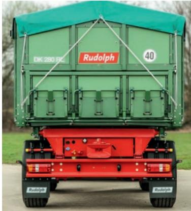
*DK 280 RL mit geteilter Rückwand und 3 Auslaufschiebern, Licht-, Druckluft- und Hydraulikanschlüsse in Fahrtrichtung links, Lkw-Beleuchtungsanlage*
