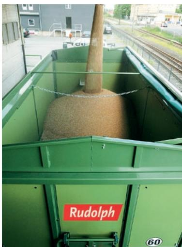
Durch ein besonderes Welger-Patent kommt der Aufbau ohne Gummidichtung aus und ist trotzdem vollkommens raps- und korndicht – so, wie Sie es von Rudolph gewohnt sind.
