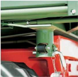
Kipplagerverriegelung mit Überkreuzsicherung
