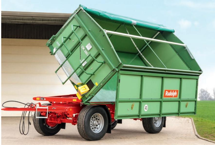
DK 280 R: Seitenwand oben pendelnd gelagert, Blechaufsatz, 250 mm hoch, feststehend
